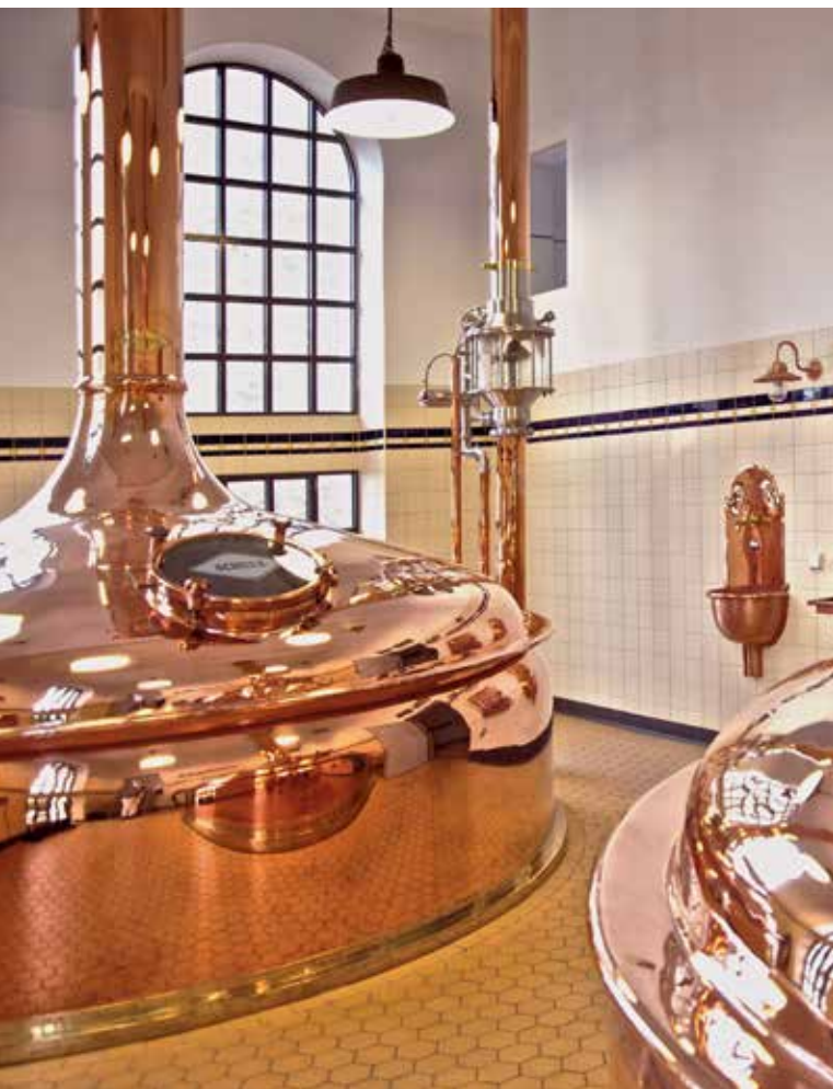
▲ Das von KASPAR SCHULZ hergestellte 90 hl 2-Geräte Sudhaus der Augustiner Brauerei in Salzburg mit den charakteristischen Kupferhauben.
